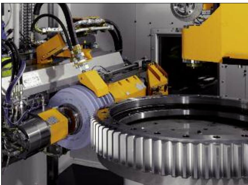
Liebherr-Schleifmaschinen sorgen für perfekte Oberflächen, hier am Beispiel einer Außenverzahnung.
