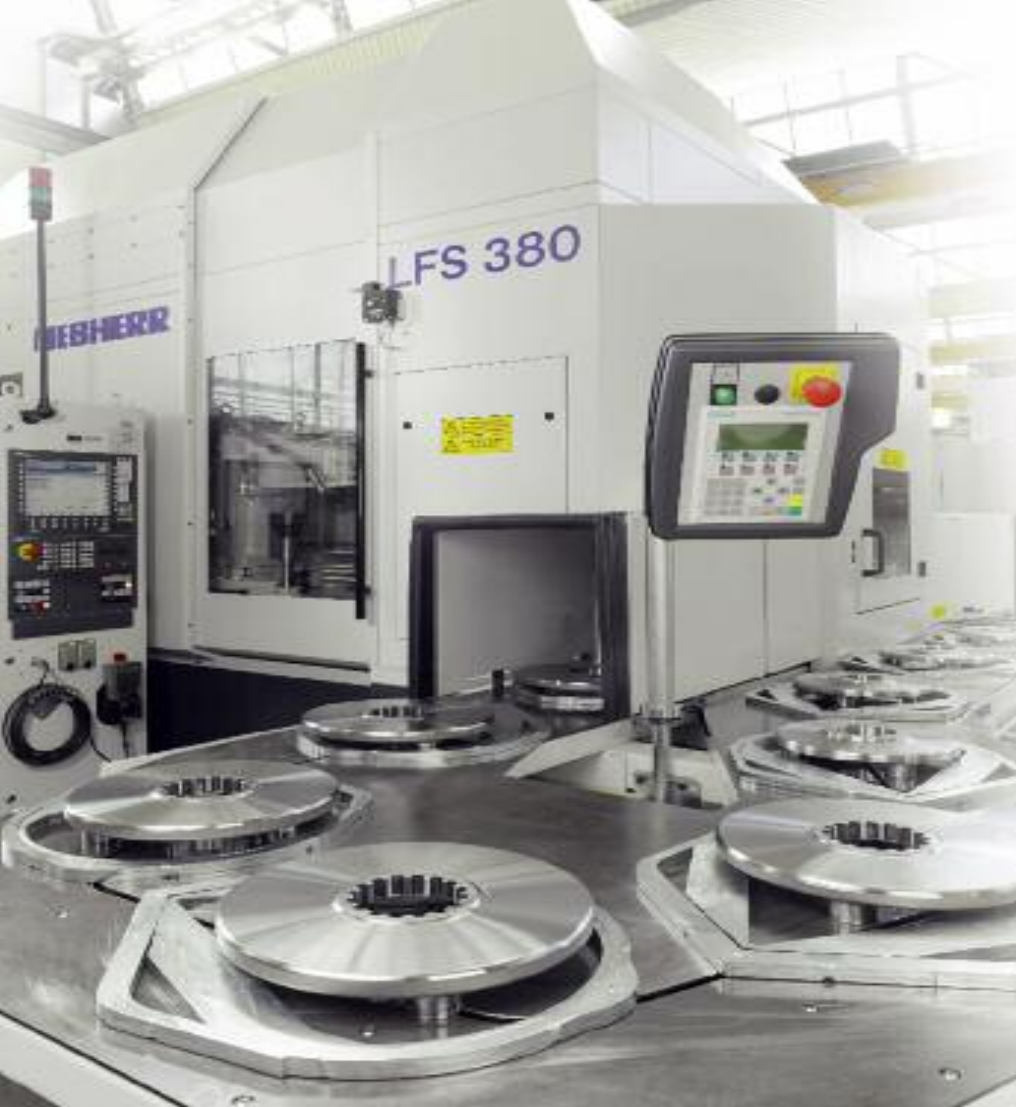
Mit Wälzstoßmaschinen von Liebherr lassen sich wirtschaftlich Innenverzahnungen herstellen. Im Bild sind Planetenträger von Drehantrieben zu sehen.
