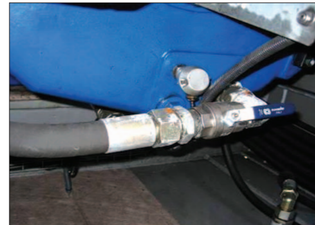
Bild 5 : Sauganschluss am Getriebe an der Stirnradstufe (vor Modifikation)
