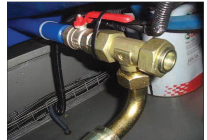
(Bild 6 : Nach Modifikation: Sauganschluss am Getriebe an der Planetenstufe.
