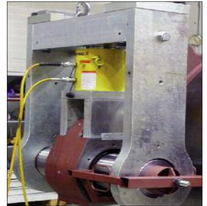
Radialer Einbau einer Spannbuchse in 3 MW Getriebe
