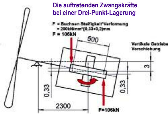
Radialer Einbau einer Spannbuchse in 3 MW Getriebe
