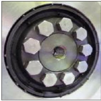
Mit neun M16-Schrauben vorgespannte Buchse
