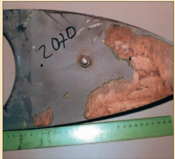
Tip Querverstärkung Bindefehler
