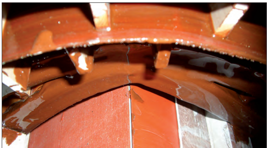
So sieht ein gereinigter und montagebereiter Trafo nach der Reparatur in der Werkstatt aus. Dieser Trafo kann wieder auf die Anlage.
