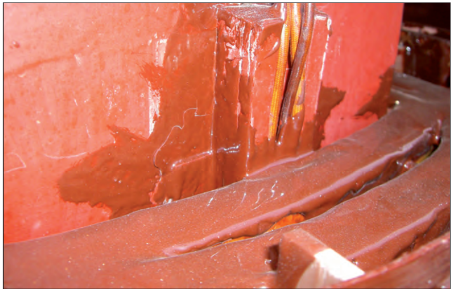
So sieht ein gereinigter und montagebereiter Trafo nach der Reparatur in der Werkstatt aus. Dieser Trafo kann wieder auf die Anlage.
