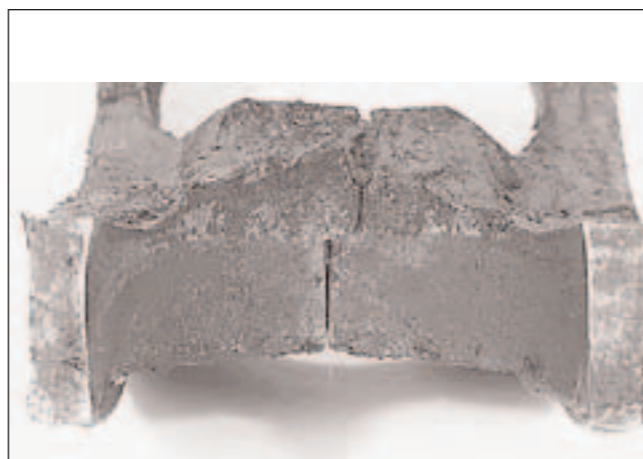
Bild 9 : Blick auf Kugelführungsfläche. Wulstförmig aufgeschichtetes Käfigmaterial W View onto ball guide surface bulge-shape coating on cage material W
