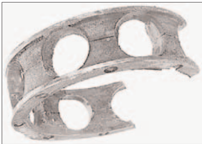
Bild 8 : Massiver Verschleiss an den Kugelführungsflächen eines Messing - Massivkäfigs Massive wear on the ball guide surfaces of a solid brass cage.
